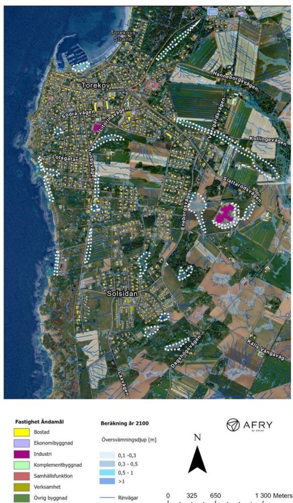
Figur 21. Kartläggning större rinnvägar och ytor med vattensamlingar Översiktsskarta centrala Torekov som visar översvämningsscenario för 2100: 100 års CDS-regn med klimatfaktor 1,25. Havsnivå +2,68 meter. Utifrån aktuella beräkningar har kartläggning av större rinnvägar gjorts som bedöms påverka planlagd bebyggelse, dessa presenteras som streckade vita områden. Källa: (AFRY, 2021).
